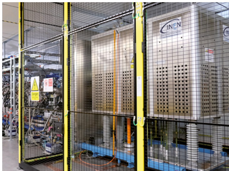
Figure 68 : Source d'ions et LEBT de l'accélérateur ESS (réalisation INFN, Italie).
