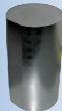
Lingot de silicium irradié à ORPHÉE leur diamètre peut atteindre 15 cm.
