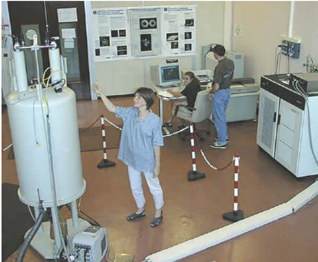
Spectromètre RMN 11,7 T équipé pour la RMN du liquide et la micro-imagerie.
