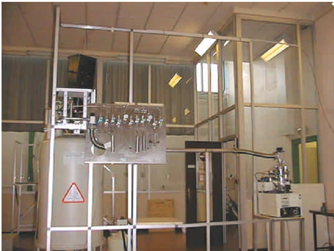
Développements instrumentaux autour d'un spectromètre RMN : système de polarisation de xénon utilisant le champ de fuite de l'aimant supraconducteur.
